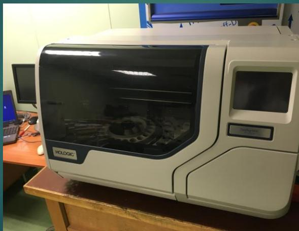
Контролируемый процессором перенос через мембрану обеспечивает необходимое число клеток для диагностики с сокращением клеток воспалительного ряда и избытка флоры
